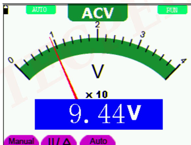
圖 26：交流電壓測量介面
