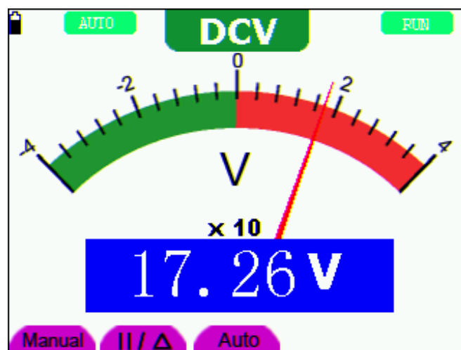
圖 25：直流電壓測量介面
